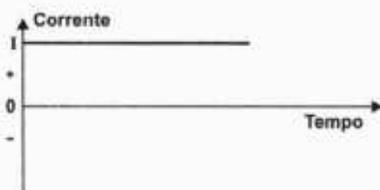
Figura 11.1 – Forma de onda contínua (C.C.) ou unidirecional
