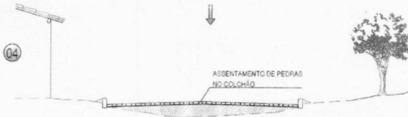
OS BLOCOS DE PEDRA TOSCAS SERÃO ASSENTES SOBRE O COLCHÃO DE AREIA EM LINHAS PERPENDICULARES AO EIXO DA PISTA, OBEDECENDO AS COTAS E ABaulamentos DO PROJETO. EM TANGENTE, O ABaulAMENTO SERÁ FEITO POR DUAS RAMPAS, OPOSTAS A PARTIR DO EIXO, COM DECLIVIDADE DE 2% SALVO OUTRA INDICAÇÃO DO PROJETO. NAS CURVAS, A DECLIVIDADE TRANSVERSAL SERÁ A INDICADA PELA SUPER-ELEVAÇÃO PROJETADA.
